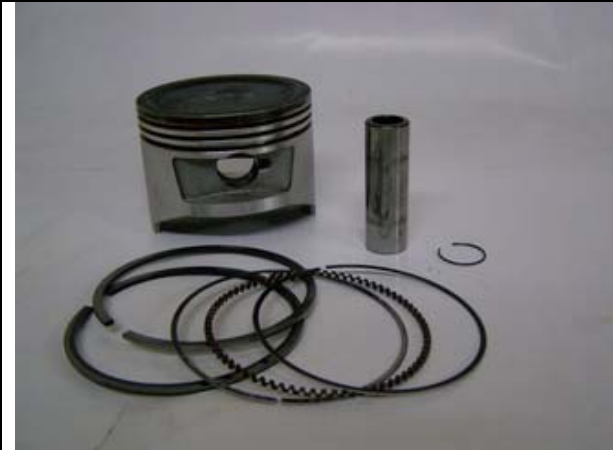
Фото: Поршень, кольца, палец и стопора
