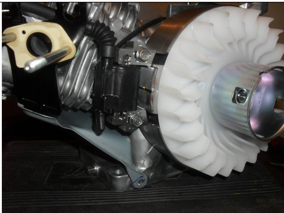
Положение элементов зажигания в 25° до ВМТ коленвала
