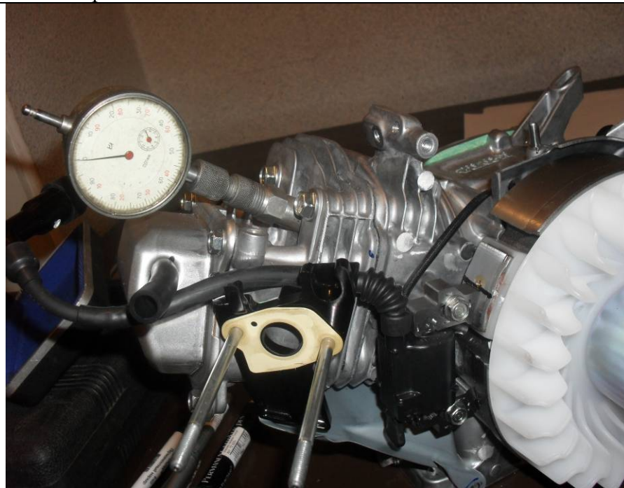
Положение элементов зажигания в ВМТ коленвала
